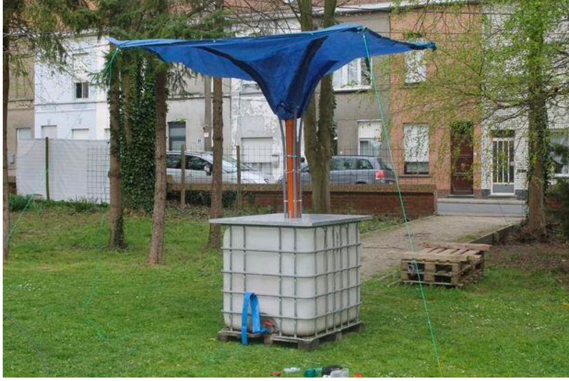
Şekil 17: Örnek bir Yağmur Suyu Toplama Mekanizması
